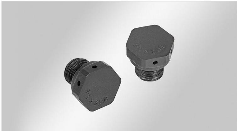
Le nouveau compensateur de pression PCE avec filetage M12 x 1,5 est utilisé pour éviter les variations de pression causées par les différences de température et éviter ainsi les dommages causés par la condensation. Il permet le respect de l'IP68.
